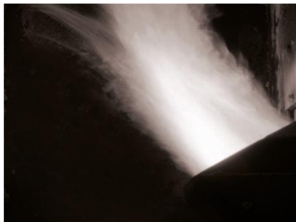
Prawidłowy ogień jest wtedy, kiedy obserwujemy, czysty, intensywnie żółty płomień.
